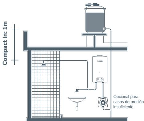
Sólo necesita **1m de altura** entre la base del tinaco y la regadera más alta, la presión de agua requerida es de 100 g/cm<sup>2</sup>
