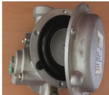
3.- Manipular la membrana en varias ocasiones de manera que la despeguemos de la base metálica.
