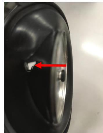
**4.- Si detectamos orificios en la membrana solicitamos válvula de gas completa.**
